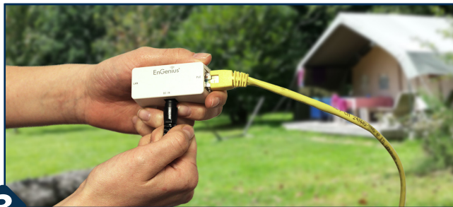
2 Verbind één einde van de Ethernet kabel (niet bijgeleverd) met de LAN (PoE)-poort van de EZ Hotspot Extender. De LAN (PoE)-poort bevindt zich rechts op de achterzijde van het product.
